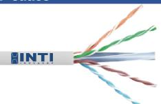
Cabo de par trançado, 4 pares de fio de cobre de alta pureza com bitola 24AWG 100% cobre. Construído com a capa externa em material retardante a chama. Categoria 5e de transmissão de dados é ideal para aplicações Fast Ethernet 100BASE-TX, 100BASE-T4, Gigabit Ethernet 1000BASE-T, Token Ring 10BASE-T e ATM-155 (UTP).
