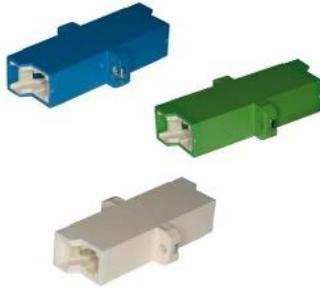
Adaptador óptico para conexão de conectores E-2000 do tipo push-pull com trava de segurança. Possui bucha de cerâmica, em seu interior, permite uma alta precisão no alinhamento dos conectores E-2000, propiciando baixas perdas de inserção nas conexões e aumentando sua performance. Apresenta tampa interna defletora para proteção contra poeira na conexão e desconexão. Está disponível nas seguintes características:
