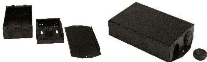
Terminador Óptico de Acesso, *INovaTI TOA7000*, para instalação em parede, bandeja ou fundo de painel, construído em aço SAE 1010/1020 ou em alumínio, dimensões AxLxP[mm] 157x96x34,5, com capacidade para fusão de até 12 fibras ópticas. Acompanha acessórios de acomodação e fixação.
