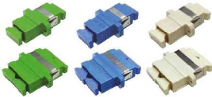
Adaptador óptico para conexão de conectores SC do tipo push-pull. Através da bucha de cerâmica, em seu interior, permite uma alta precisão no alinhamento dos conectores SC, propiciando baixas perdas de inserção nas conexões e aumentando sua performance. Apresenta tampa removível para proteção contra poeira. Está disponível nos seguintes modelos
