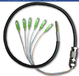
Cabo óptico Service Cable, para instalações *outdoor*, conectorizado com conectores E-2000, FC, LC, SC ou ST, em uma extremidade. Capacidade de 02 à 12 fibras ópticas.
